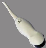
Largeur de sonde à son extrémité 0.91 cm, largeur maximale du manche de la sonde 2.78 cm, longueur du câble 2.1 m.
