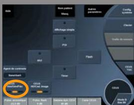
**Résolution/Pénétration en mode CEUS** agit sur l’image CEUS et permet d’obtenir une plus grande résolution de contraste ou une plus grande pénétration.
