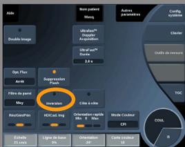
**Inversion** permet de visualiser le flux sanguin d'un point de vue inversé, c'est-à-dire le rouge correspondant aux particules s'éloignant (vitesses négatives) et le bleu correspondant aux particules se rapprochant de la sonde (vitesses positives).
