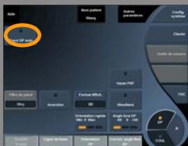
Cette commande permet de réaliser des mesures DP automatiques.
