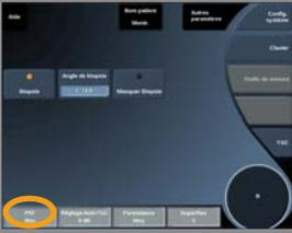
**PRF** permet de modifier la fréquence de répétition de l'image en mode B.
