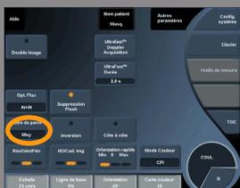
Ce paramètre permet de filtrer les signaux de tissus ayant de faibles vitesses.
