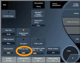
**Haute Définition/Cadence Image** permet d'ajuster la cadence image et la densité de ligne pour accroître la résolution spatiale ou temporelle.
