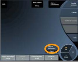
**Vitesse de défilement** permet de changer la vitesse à laquelle les colonnes du mode spectral sont mises à jour.
