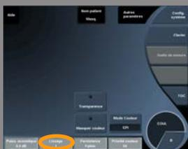
**Lissage** est un filtre spatial destiné à lisser l'image couleur afin d'obtenir une apparence plus homogène.
