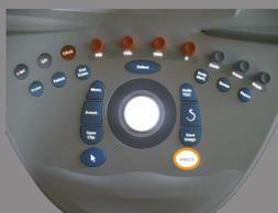
Lorsque vous êtes en mode Imagerie en direct, appuyez sur **Figer** sur le panneau de contrôle pour figer l'image. Un flocon apparaît sur l'image pour indiquer que l'image est figée.
