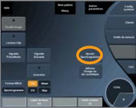
En mode Doppler UltraFast™, l'utilisateur peut ajouter jusqu'à 3 volumes d'échantillon sur l'image révisée afin de calculer des spectrogrammes simultanés.
