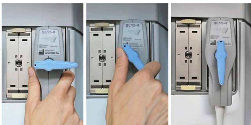
Pour déconnecter une sonde, tourner son verrou d'un quart de tour dans le sens inverse des aiguilles d'une montre pour la déverrouiller et retirer son connecteur de son logement.
