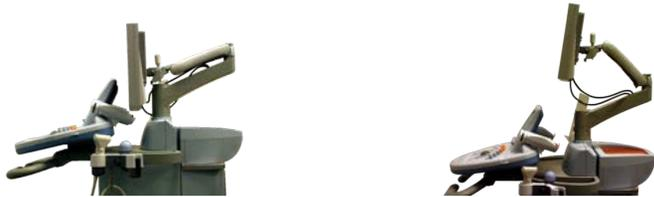
Lorsqu'il est déverrouillé de sa position de transport, le moniteur peut être orienté autour de son axe vers le haut ou vers le bas, tourné vers la droite ou la gauche, ou glissé d'un côté vers l'autre.
