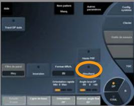
**Le mode Simultané** permet une évaluation en temps réel de la vascularisation lorsque celle-ci est difficile à évaluer avec le mode DP seul.
