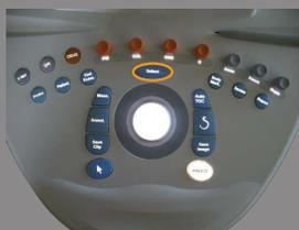
Pour naviguer dans les onglets, déplacez le curseur sur l'onglet que vous voulez ouvrir et appuyez sur **Select.** sur le panneau de contrôle.
