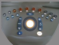
Déplacez **la trackball** de gauche à droite, pour déplacer la ligne M latéralement dans l'image 2D.
