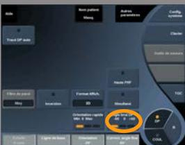
**Correction d'angle** est disponible en temps réel et sur une image figée.
