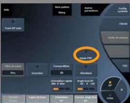
**Haute PRF** permet de mesurer des flux plus élevés que ceux qui peuvent être mesurés avec l'échelle traditionnelle maximale, en augmentant la PRF (Pulse Repetition Frequency) au-delà de la limite de Nyquist et en évitant l'aliasing.
