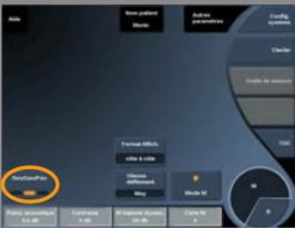
**Résolution/Pénétration** vous permet de changer la fréquence centrale pour obtenir une plus grande résolution ou pénétration. **Résolution/Pénétration** est accessible uniquement en mode imagerie en direct. Appuyez sur **Résolution/Pénétration** pour changer la valeur.
