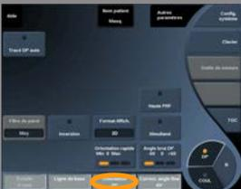
On peut changer l'orientation du faisceau ultrasonore du mode Doppler Pulsé pour être le plus parallèle à la direction du mouvement dans les limites physiques des transducteurs et de la géométrie des vaisseaux interrogés.
