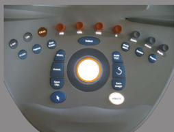
Déplacez **la trackball** de gauche à droite, pour déplacer la ligne de Doppler latéralement dans l'image 2D.
