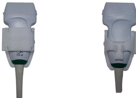
Lors du montage du support sur le transducteur, assurez-vous que les flèches sur le côté du support et du transducteur sont alignées (voir l'image ci-dessous).
