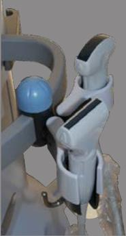
Le système possède quatre connecteurs de sondes qui peuvent être utilisés en même temps, mais une seule sonde peut être utilisée à la fois. Quand une sonde n'est pas utilisée, la stocker dans un des portes-sonde. Toujours utiliser le système de gestion du câble pour éviter de marcher sur les câbles ou que le système ne roule dessus.
