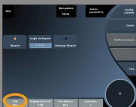
**PRF** permet de modifier la fréquence de répétition de l'image en mode B.
