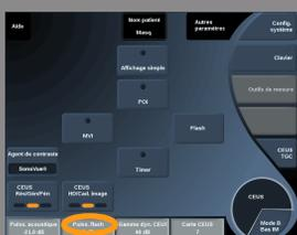
**Puissance de Flash** règle la puissance acoustique émise par le système en mode CEUS pendant la séquence de Flash.
