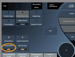
**Rés/Gen/Pén** vous permet de changer la fréquence centrale pour obtenir une plus grande résolution ou pénétration. **Rés/Gen/Pén** est accessible uniquement en mode imagerie en direct. Appuyez sur **Rés/Gen/Pén** pour changer la valeur.
