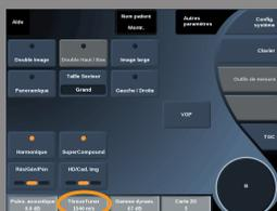
**TissueTuner™** permet d'ajuster la vitesse du son en fonction du type de tissu imagé, ce qui a pour effet d'augmenter la résolution latérale et de contraste.
