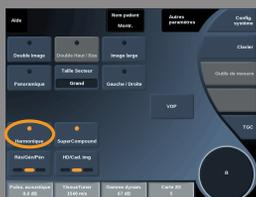
Le mode d'imagerie harmonique est utilisé pour réduire les artefacts ultrasonores et la réverbération et mettre en valeur les contours.
