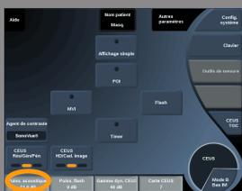
**Puissance Acoustique en mode CEUS** régule la puissance acoustique émise par le système en mode CEUS.
