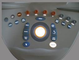
Déplacez le **trackball** de gauche à droite, pour déplacer la ligne Doppler latéralement dans l'image 2D.
