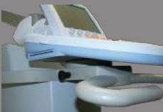
1. Tirer le levier situé sous le panneau de contrôle pour le déverrouiller
