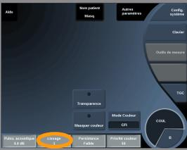
**Lissage** est un filtre spatial destiné à lisser l'image couleur afin d'obtenir une apparence plus homogène.
