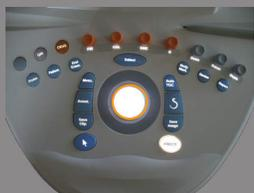
Déplacez le **trackball** de gauche à droite, pour déplacer la ligne M latéralement dans l'image 2D.
