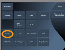
L'outil **Vitesse** produit une mesure de vitesse du Doppler (Vel) (en cm/s) et un calcul de gradient de pression (PG) (en mmHg).
