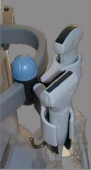
Le système possède quatre connecteurs de sondes qui peuvent être utilisés en même temps, mais une seule sonde peut être utilisée à la fois. Quand une sonde n'est pas utilisée, la stocker dans un des portes-sonde. Toujours utiliser le système de gestion du câble pour éviter de marcher sur les câbles ou que le système ne roule dessus.
