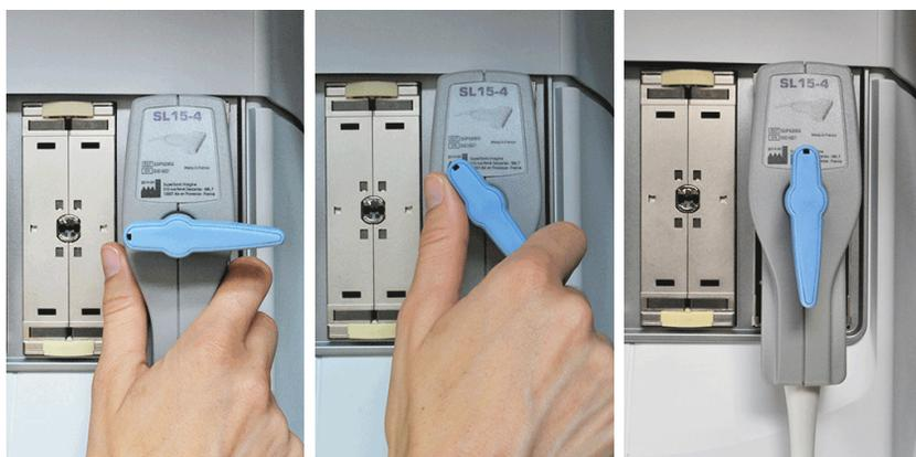
Zum Trennen des Schallkopfes drehen Sie den Hebel gegen den Uhrzeigersinn, um den Schallkopfstecker zu lösen, fassen den Stecker an und ziehen ihn gerade heraus.
