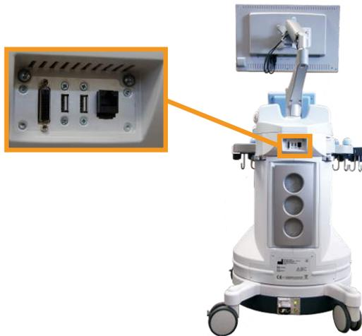
An diesen Port kann ein DVI-fähiger Monitor angeschlossen werden.
