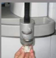
1. Platzieren Sie den unteren Teil der Kabelhalterung auf dem Ring unter dem Bedienpult.
