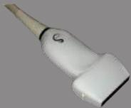
Breite der Schallkopfauflagefläche 5.92 cm; Kabellänge 2,1 m
