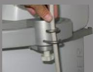
1. Nachdem die Kabelhalterung angebracht ist, führen Sie das Schallkopfkabel durch die zwei Haken.
